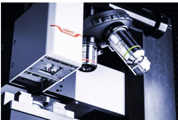
Abbildung 8: Das UNHT 3 Ultra-Nanoindentationsgerät mit der patentierten Oberflächenreferenzierung.
